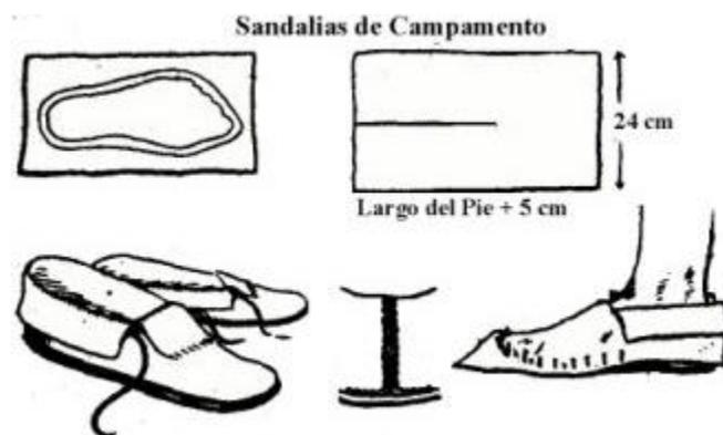
Para el empeine se necesita un pedazo de cuero más blando, de unos 24 cm. de ancho y de un largo en el que quepa tu pie más 5 cm. Se hacen dos cortes: uno de unos 15 cm. de largo perpendicular al ancho del cuero y otro de 6 cm. perpendicular al primero, como se ve en la figura. Coloca tu pie sobre el trazo de la plantilla y el cuero arriba del empeine, y sigue el contorno fijando clavitos, cuidando que la forma quede bien regular.
