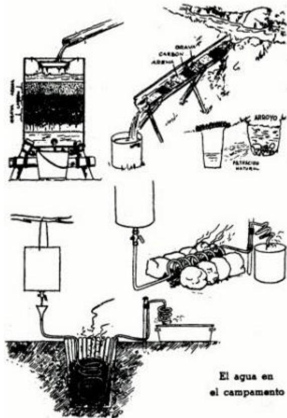
Puede desviarse el agua de una acequia por un pequeño canal previamente llenado con piedras, arena y carbón vegetal triturado, colocados en secciones sucesivas. Este canal puede hacerse de tejas, cortezas o de un tronco ahuecado. La longitud mínima del mencionado canal filtrante debe ser de un metro, y si excediera de tres metros resultaría completamente inútil.
