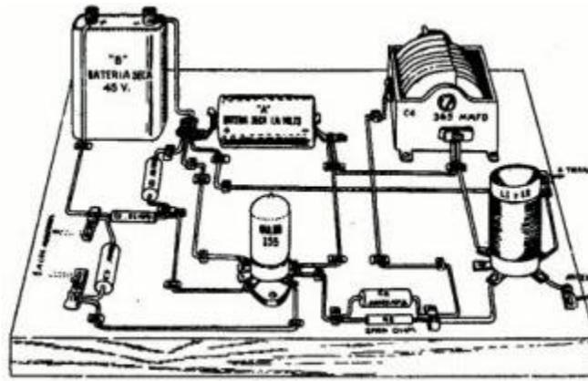
Una vez montado tu aparato, alguien de la Patrulla puede hacerle su caja que semeje un radio convencional. Para apagarlo, basta retirar la batería "A".
