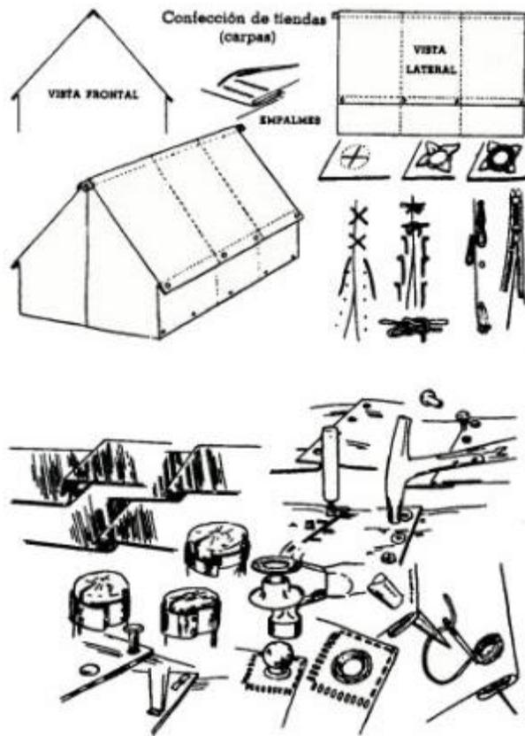
Por el interior del dobléz se cose una banda de tela gruesa y resistente de 10 cm. de ancho, con todos los bordes dobladillos, que sobrepasará en 5 cm. a la tela de la tienda. En cada uno de los extremos sobresalientes se pone un ojillo metálico o arandela para recibir las cuerdas que mantendrán la tienda en pie.
