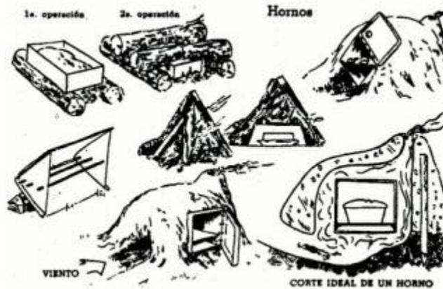
**Fogones y hornos con chimenea.** Todo cocinero ambicioso encontrará que un fogón abierto tiene sus limitaciones, y que no es difícil construir uno *con chimenea*. Se hace como el fogón en zanja y se le completa con un túnel para el tiro, que se termina al exterior con una chimenea de ladrillos, piedras o barro mezclado con zacate o pasto.
