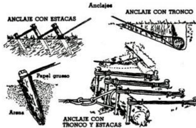
**Anclaje con estacas.** Las tres estacas que lo forman deben ser de un poco más de un metro de largo y hasta de unos ocho centímetros de grueso, dependiendo de la tensión que vayan a resistir.
